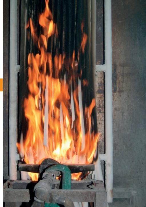
Le revêtement de câble Firebreak C100 est un revêtement à base d'eau durable et résistant au feu conçu pour être utilisé sur les installations de câbles conventionnelles. En cas d'incendie, il empêche la propagation des flammes le long des chemins de câbles horizontaux et verticaux et peut également être utilisé pour maintenir l'intégrité du circuit des câbles d'alimentation et de commande critiques jusqu'à 2 heures.
