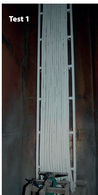
Câbles revêtus avant le début du test
