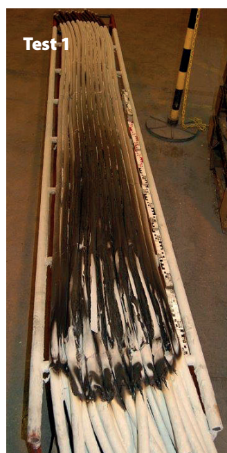
Dommages limités aux câbles après test
