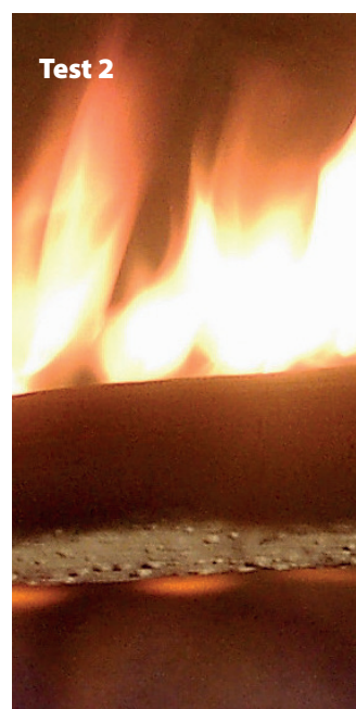
Câble haute tension exposé à une flamme de 700°C
