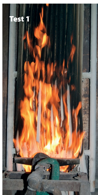
Câbles revêtus exposés à un brûleur à gaz de 20kW pendant le test
