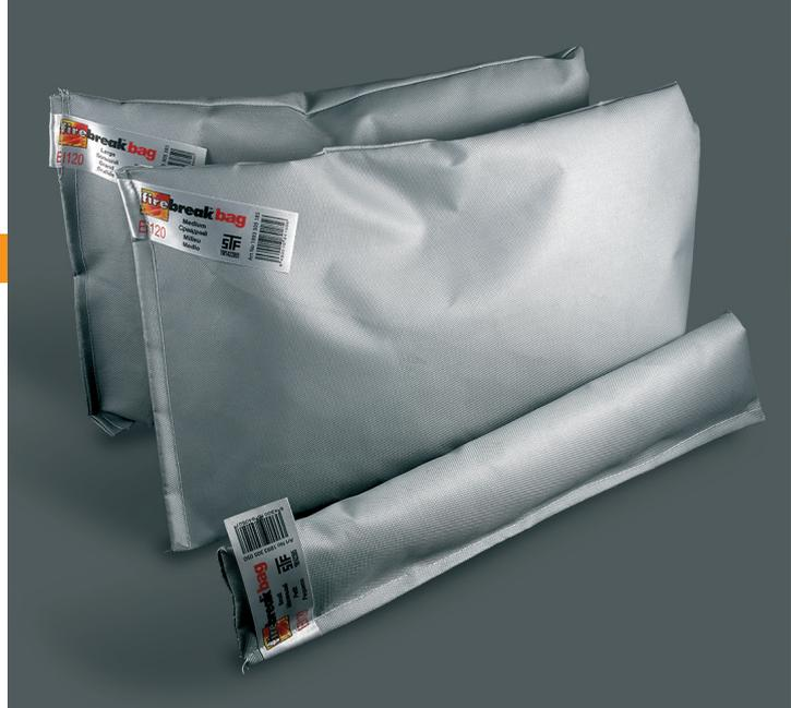
Les coussins coupe-feu se composent d'une gamme de sacs en tissu de verre enduit de différentes tailles remplis d'un mélange de charges intumescentes et inertes durables. Ils sont conçus pour être installés autour des installations dans des murs coupe-feu continus pour fournir une étanchéité au feu temporaire ou permanente jusqu'à 120 minutes.
