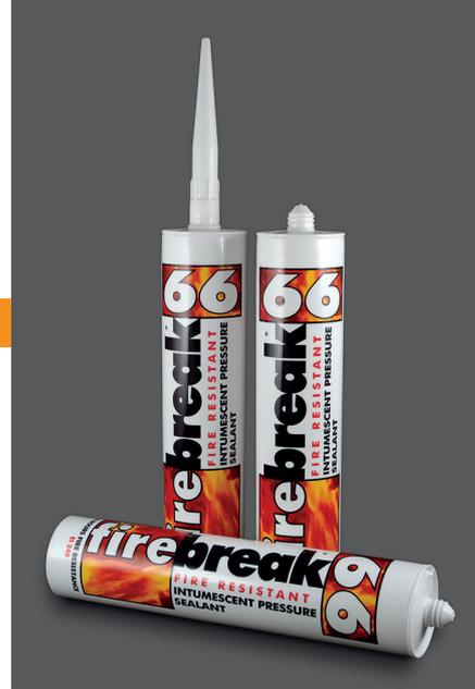
Firebreak 66 est un mastic acrylique intumescent à 1 composant qui se dilate en cas d'incendie avec une pression élevée pour sceller les ouvertures dans la structure du compartiment coupe-feu lorsqu'il est acheminé avec des tuyaux en plastique, des tuyaux métalliques avec isolation combustible et des câbles groupés.
