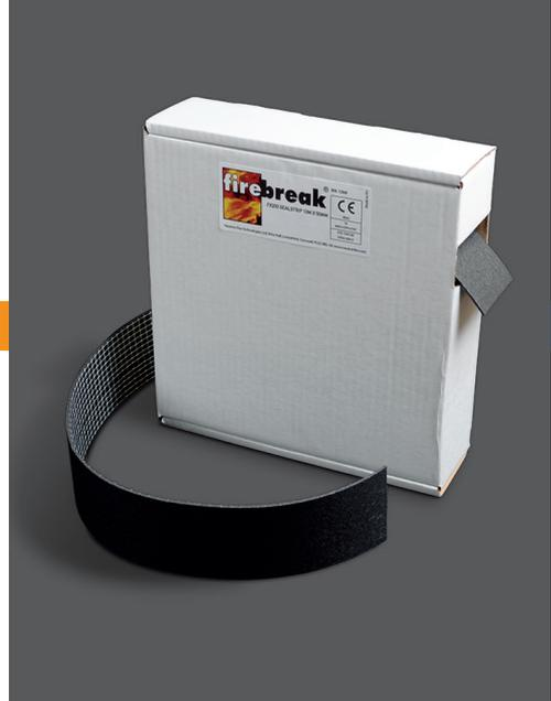
La bande coupe-feu Firebreak FX200 est un matériau intumescent durable fourni sous la forme d'un rouleau continu de 10 m emballé dans une boîte auto-dosante pratique pour une coupe à longueur et sur site selon les besoins. Ils sont conçus pour être installés autour de tuyaux en plastique et en métal avec une isolation combustible et là où de telles pénétrations pénètrent dans des murs ou des sols résistants au feu avec un joint coupe-feu pendant jusqu'à 240 minutes.
