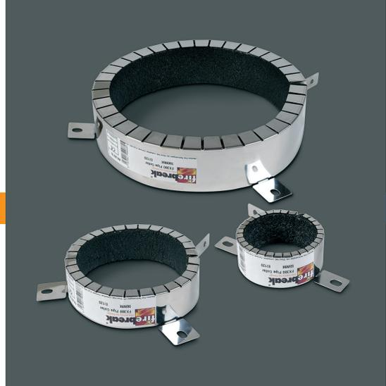
Les colliers coupe-feu Firebreak FX300 se composent d'une gamme conçue pour être montée tout autour: des tuyaux plastiques ou des tuyaux métalliques et plastiques isolés à l'endroit où ils pénètrent dans les constructions résistantes au feu. En cas d'incendie, le matériau intumescent dans le manchon se dilate pour écraser le tuyau de l'adoucisseur et/ou l'isolant combustible et remplir l'espace résultant tout en maintenant la résistance au feu et les performances d'isolation du sol ou du mur.
