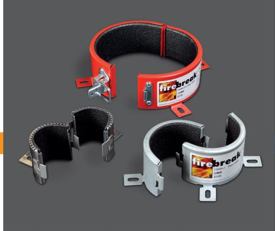
Les colliers coupe-feu Firebreak FX400 se composent d'une gamme conçue pour être montée tout autour: des tuyaux plastiques ou des tuyaux métalliques et plastiques isolés à l'endroit où ils pénètrent dans les constructions résistantes au feu. En cas d'incendie, le matériau intumescent dans le manchon se dilate pour écraser le tuyau de l'adoucisseur et/ou l'isolant combustible et remplir l'espace résultant tout en maintenant la résistance au feu et les performances d'isolation du sol ou du mur.
