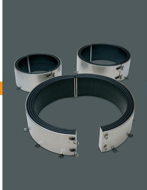
Les colliers coupe-feu Firebreak FX500 sont une gamme conçue principalement pour être installée autour de gros tuyaux en plastique où ils pénètrent dans des structures coupe-feu. Dans des conditions d'incendie, le matériau intumescent dans le manchon autour du tuyau d'adoucissement se dilate et remplit l'espace résultant, préservant l'intégrité au feu et les performances d'isolation du sol ou du mur.
