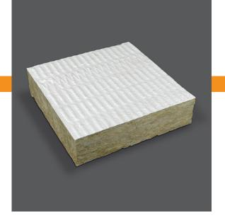
Les panneaux coupe-feu sont des dalles de laine de roche enduites sur les deux faces d'un revêtement souple ablatif résistant au feu. Ils sont utilisés pour former des joints coupe-feu et pare-fumée qui peuvent restaurer la résistance au feu des cloisons et des planchers lorsqu'ils sont pénétrés par une large gamme de services de construction.
