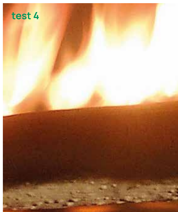
Hoogspanningskabel blootgesteld aan een vlam van 700°C
