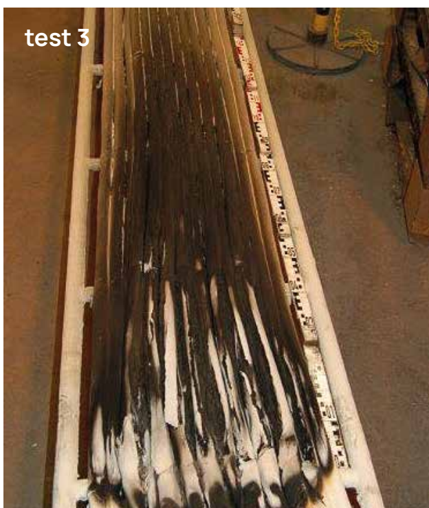
Beperkte schade aan kabels na test
