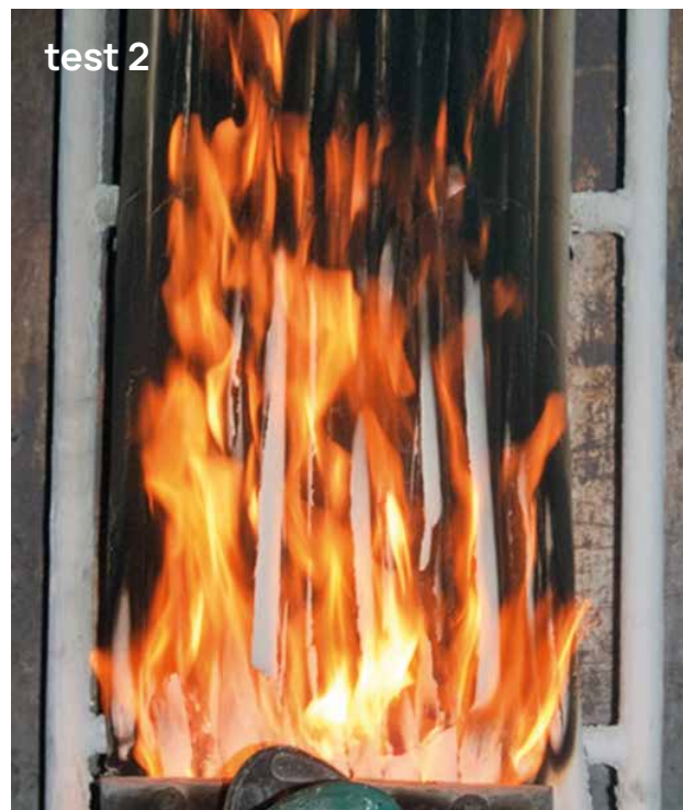
Gecoate kabels blootgesteld aan 20kW gasbrander tijdens test
